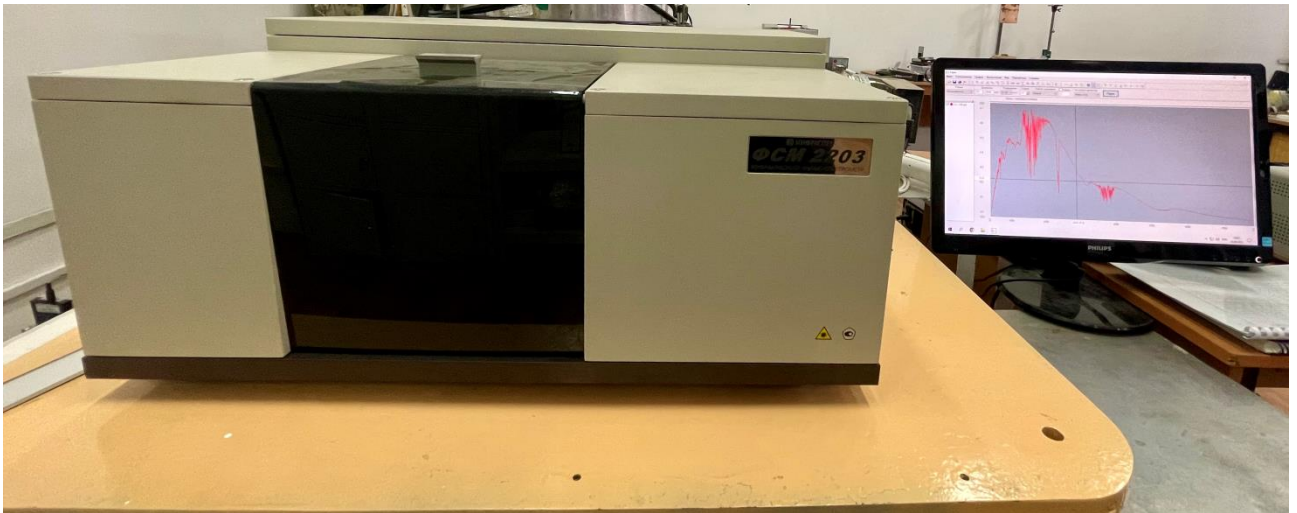
4.2 сурет – FCM 2203 типті FTIR спектрометр құралы
